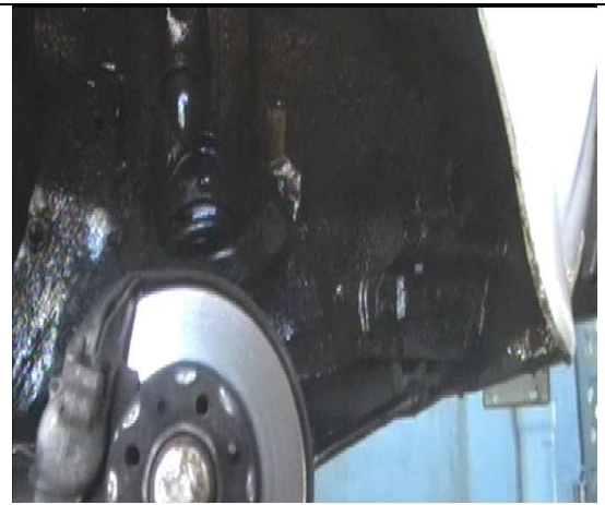
Fig. 2. Guardafangos delantero, con igual solución para la protección interior. Observe el recubrimiento de grasa aplicada interiormente.
